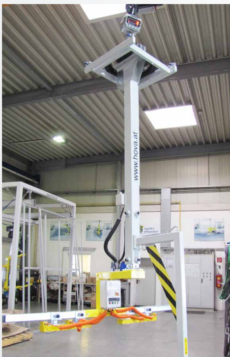
MAGNETHEBER MIT LASTFÜHRUNG
